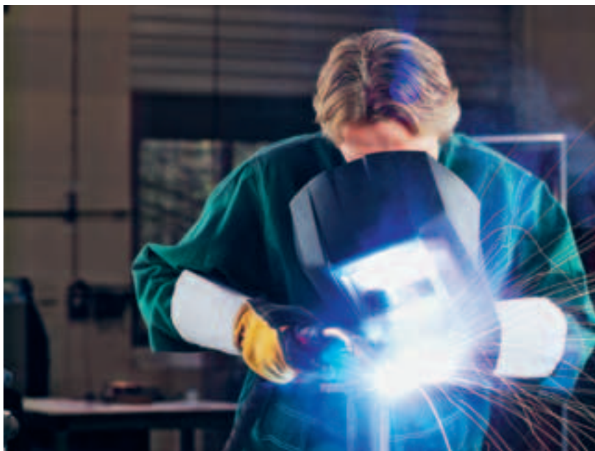
Aktive Schweißhelme – das Kerngeschäft von Optrel – dunkeln beim Schweißen selbständig ab.
